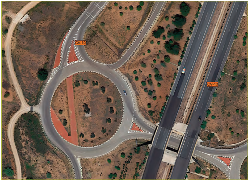
Fotografía 44.- Vista aérea del enlace tipo glorieta de CV-10 con CV-13. (Fuente: Google Earth)
