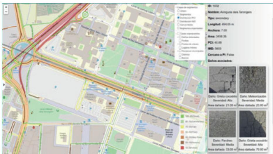
Figura 4. Identificación de daños y estimación de la condición.
