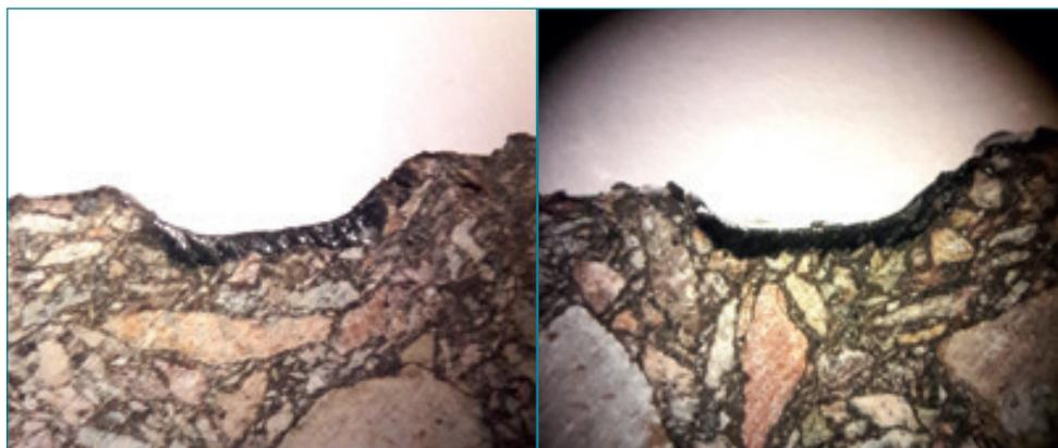
Figura 3. Disposición del riego lograda en laboratorio.
