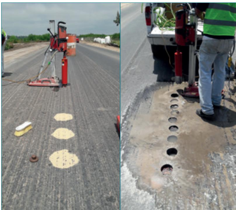
Figura 9. Determinaciones análogas al Ensayo de Parche de Arena efectuadas.
