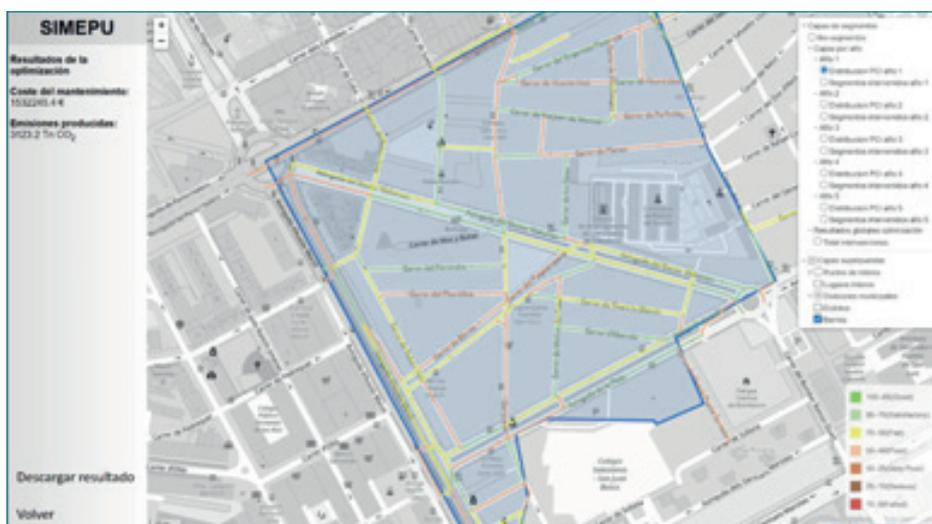
Figura 5. Predicción de la condición del pavimento: distrito de En Corts (Valencia).
