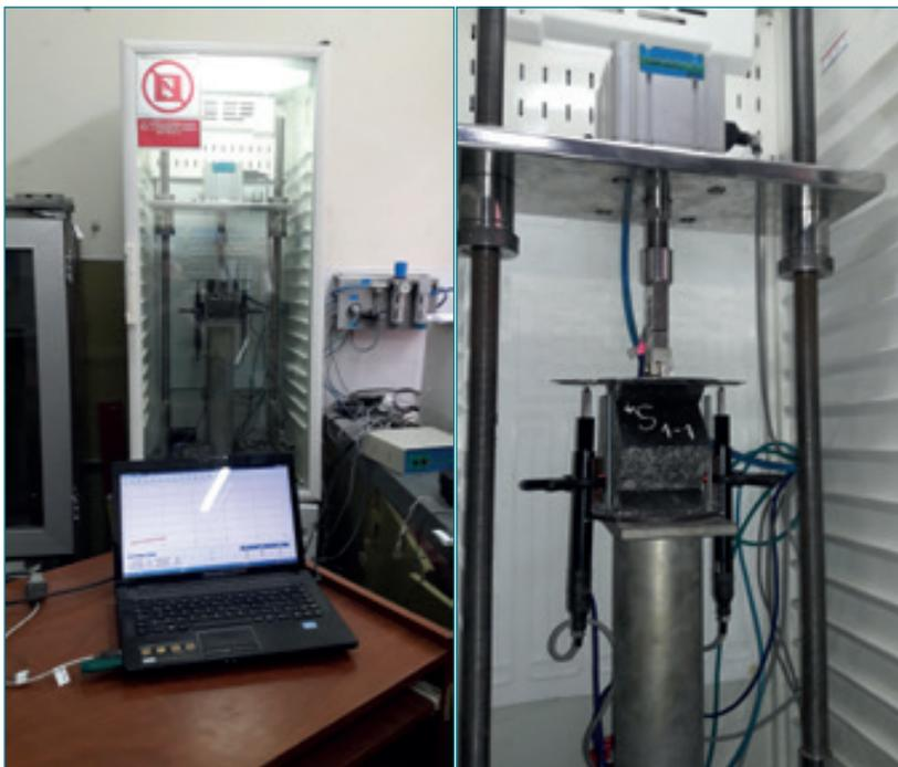
Figura 5. Imágenes durante el ensayo a fatiga de una de las probetas cúbicas.
