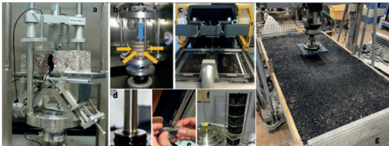
**Figura 1.** Detalle de algunos de los ensayos realizados en LabIC.UGR para el diseño y desarrollo de MASAI: (a) UGR-FACT; (b) Triaxial; (c) rodadura sumergido; (d) reología; (e) DMA; (f) SATS; (g) ensayos a escala 1:1.
